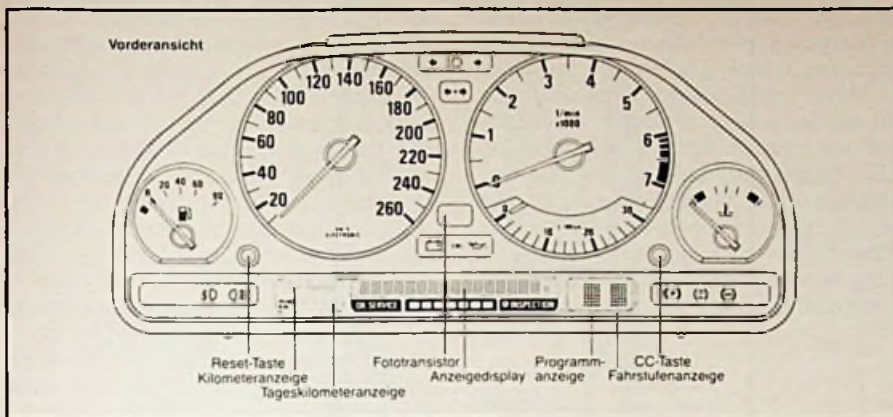
Afb. 1 Het dashboard is zowel uitgerust met wijzerinstrumenten als met alfanumerieke (matrix)display's. De analoge snelheidsmeter werkt langs elektronische weg, evenals de toerenteller en de verbruiksmeter (L/100 km).
